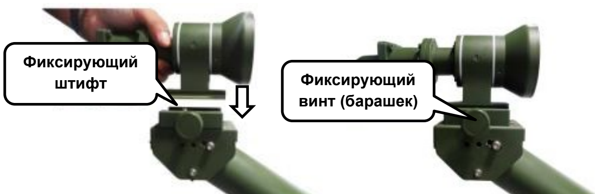
Рисунок 29 - Установка облучателя.
